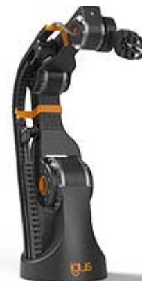
Slika 1: Robolink® D – z direktnim pogonom
