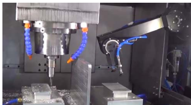
Slika 3: Robolink® D v orodju za strojno obdelavo
