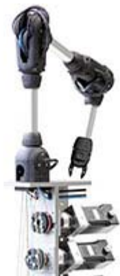
Slika 2: Robolink® W – z žičnimi vrvicami
