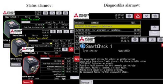
Slika 3: Vizualizacija statusa naprave in napredna diagnostika alarmov
