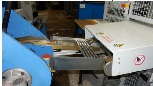
Slika 4: Izhod žage povezan z robotsko celico
