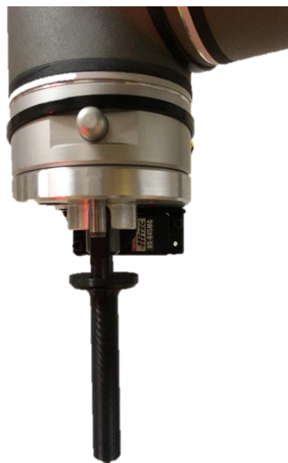
Slika 3: Prijemalo - skupek plašča valja, merilnega trna (v središču plašča valja) in servo motorja (v ozadju).
