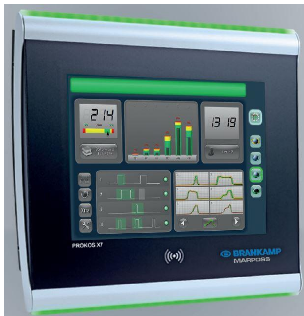
Slika 2: Procesni nadzorni sistem BRANKAMP MARPOSS X7 za nadzor nevidnih mehanskih cikličnih procesnih parametrov sile, akustike, ultraemisije, z umetno inteligenco, s signali za ustavitev stroja v nekaj milisekundah po prekoračitvi meje procesa, deluje pri delovnih ciklih preko 2000/minuto, za 100% kontrolo 0PPM med procesom, s 24 analognimi vhodi-senzorji, 20 binarnimi vhodi/izhodi hkrati, z avtomatskim učnim postopkom nastavljanja mej procesov, avtomatskim diagnosticiranjem,... ( www.brankamp.com )
