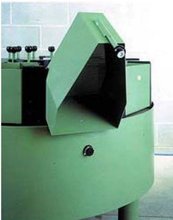
Slika 5: Posoda vrtljiva okrog vodoravne osi za stresanje kosov v zaboj brez dviganja [3]
