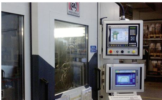
Slika 13: Procesni nadzorni sistem Brankamp Marposs dograjen na preoblikovalni stroj – spodnji ekran [2]
