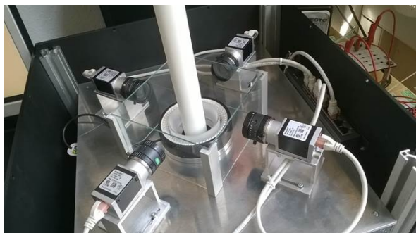
Slika 4: Zaznavanje napak na tulcih s štirimi kamerami.
