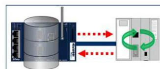
Slika 2: Izmenjava podatkov med PLC in eWON napravo.
