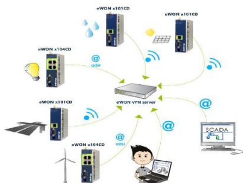
Slika 4: Prikaz arhitekture VPN strežnika z uporabo eFive naprave.
