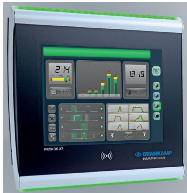
Slika 2: Procesni nadzorni sistem BRANKAMP MARPOSS X7 za nadzor nevidnih mehanskih cikličnih procesnih parametrov sile, akustike, ultraemisije, z umetno inteligenco, s signali za ustavitev stroja v nekaj milisekundah po prekoračitvi meje procesa, deluje pri delovnih ciklih preko 2000/minuto, za 100% kontrolo 0PPM med procesom, s 24 analognimi vhodi-senzorji, 20 binarnimi vhodi/izhodi hkrati, z avtomatskim učnim postopkom nastavljanja mej procesov, avtomatskim diagnosticiranjem,...
