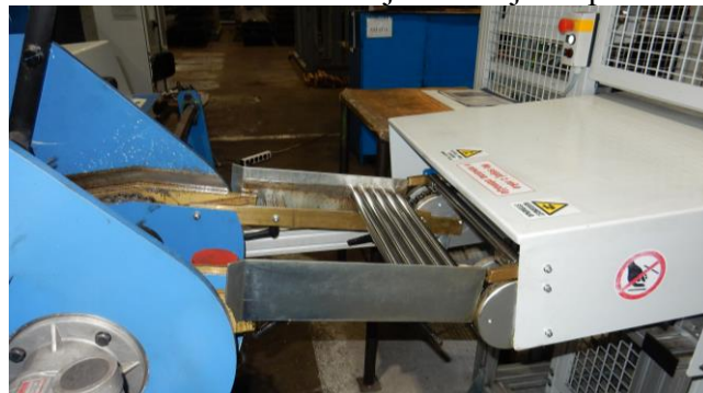
Slika 4: Izhod žage povezan z robotsko celico
