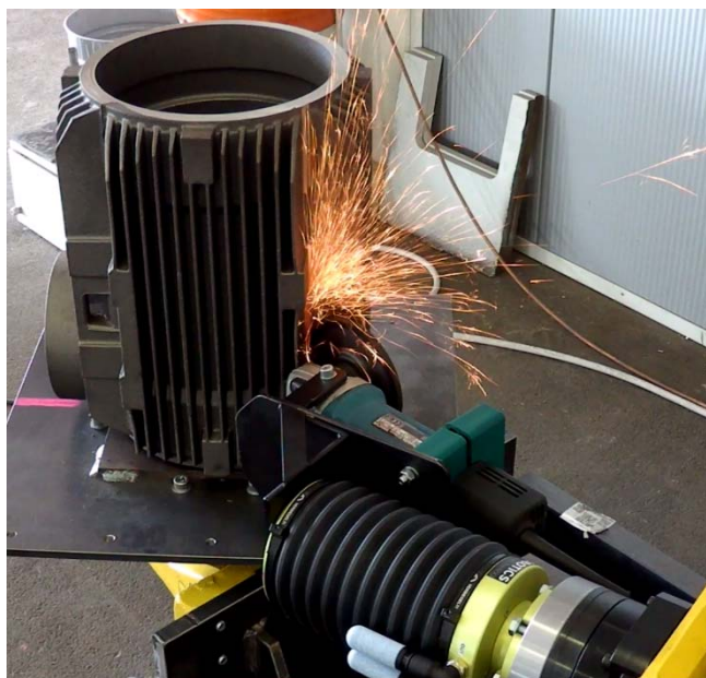
Slika 7: brušenje ohišja elektromotorja-peščeni liv
