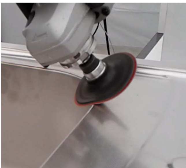
Slika 5: brušenje in poliranje RF izdelkov Funkcijski paketi
