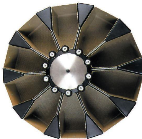
Slika 6: Vzporedne stranice posod (na mestu pritrditve z osjo) z nosilnimi trikotnimi stebri [3]
