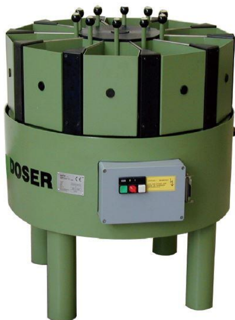
Slika 4: Dozirni sistem 10 vrtljivih posod dozomat za avtomatizacijo SPC kontrole proizvajalca Serte [3] ( www.serte.com )
